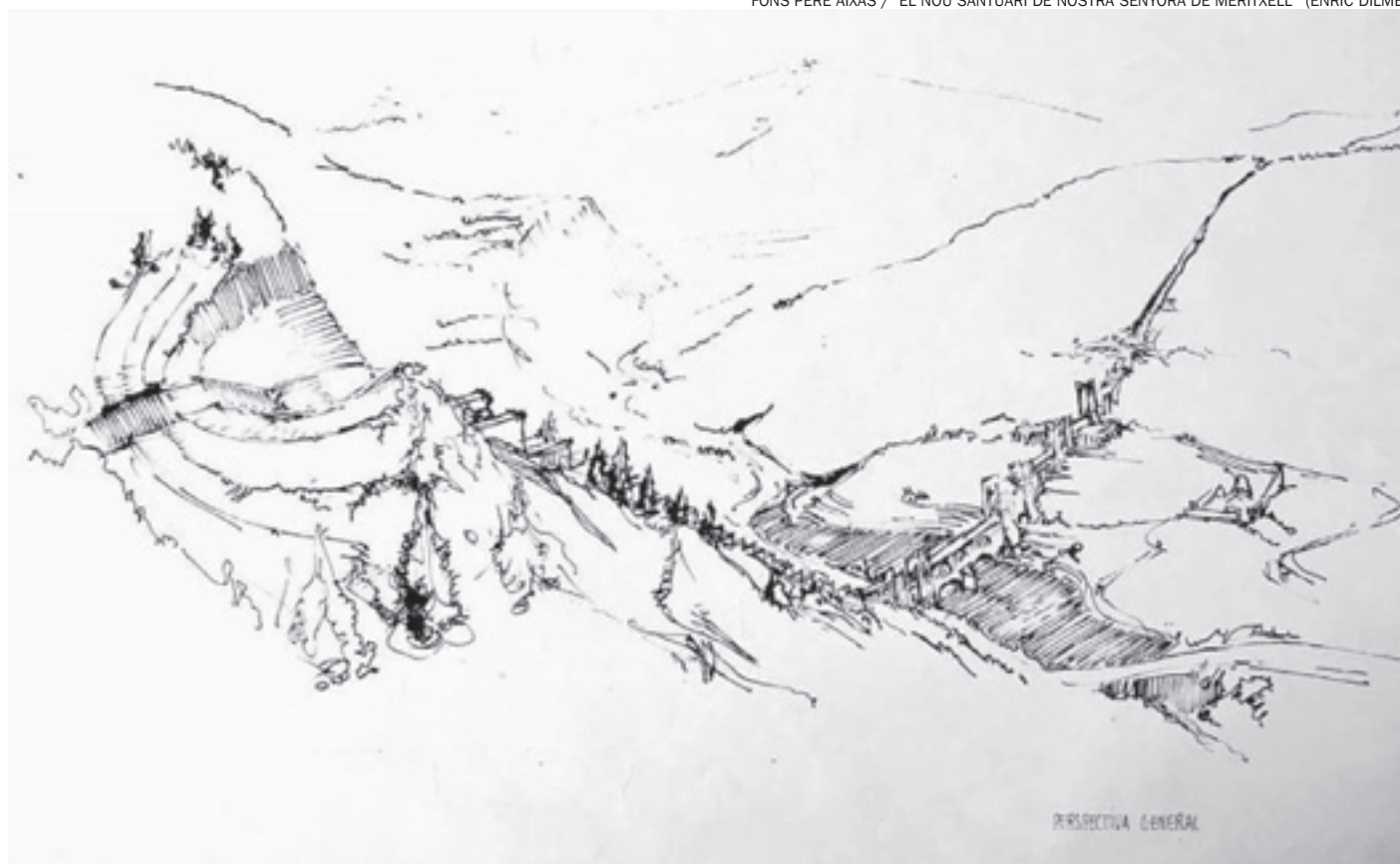
Croquis del projecte original del santuari, amb el pont que travessava la vall de costat a costat, l'escalinata, l'amfiteatre i el llac artificial.
